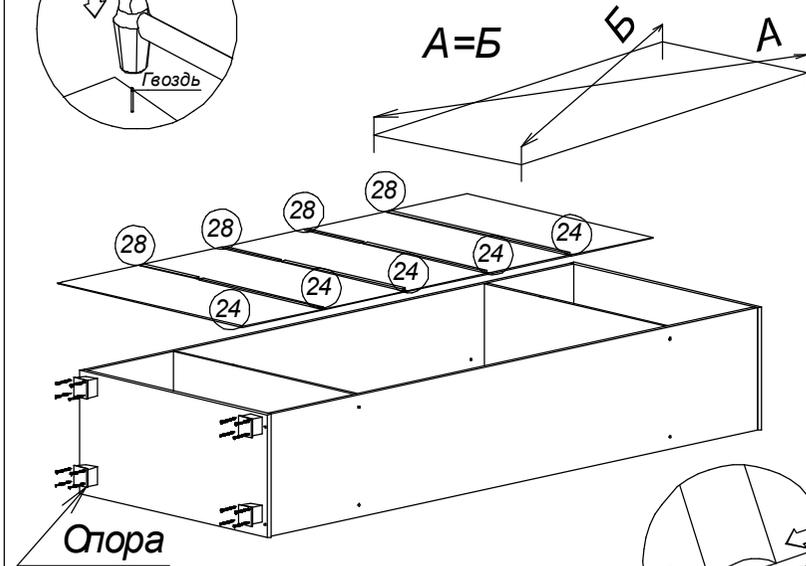
Опоры крепить к нижней крышке шурупами 4x16мм. Согласно схеме.
