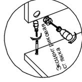
Сторы крепить к нижней крышке шурупами 4x16мм. Согласно схеме.
