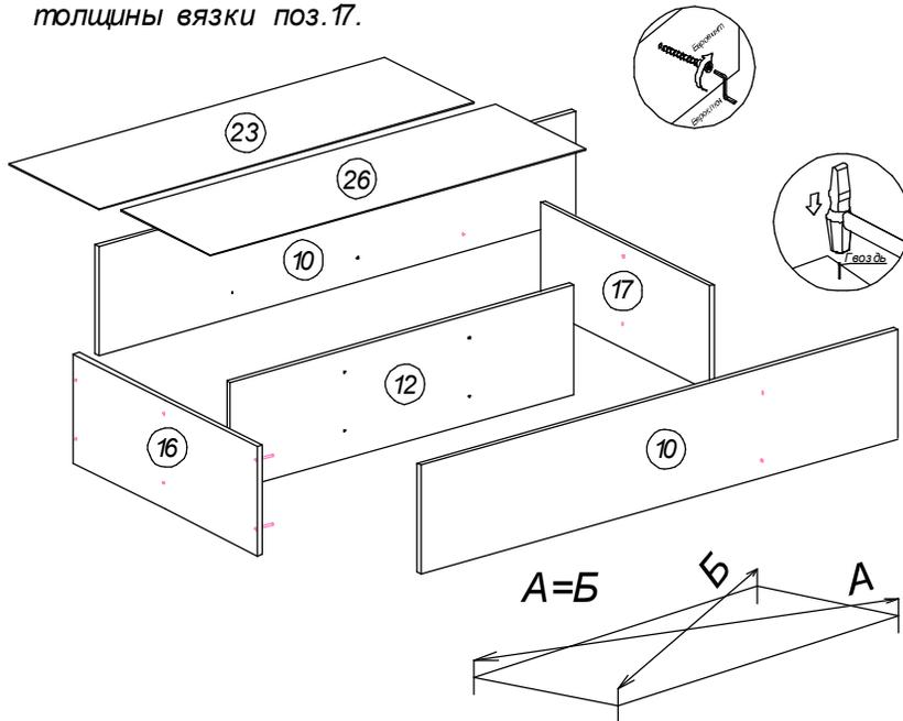
ЛДВП на стъке крепить при помощи саморезов 4.2\*14 мм (прессшайб)
