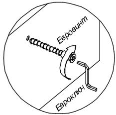
Соединить крышки и вязки с боковинами при помощи евровинтов и флипперов.
