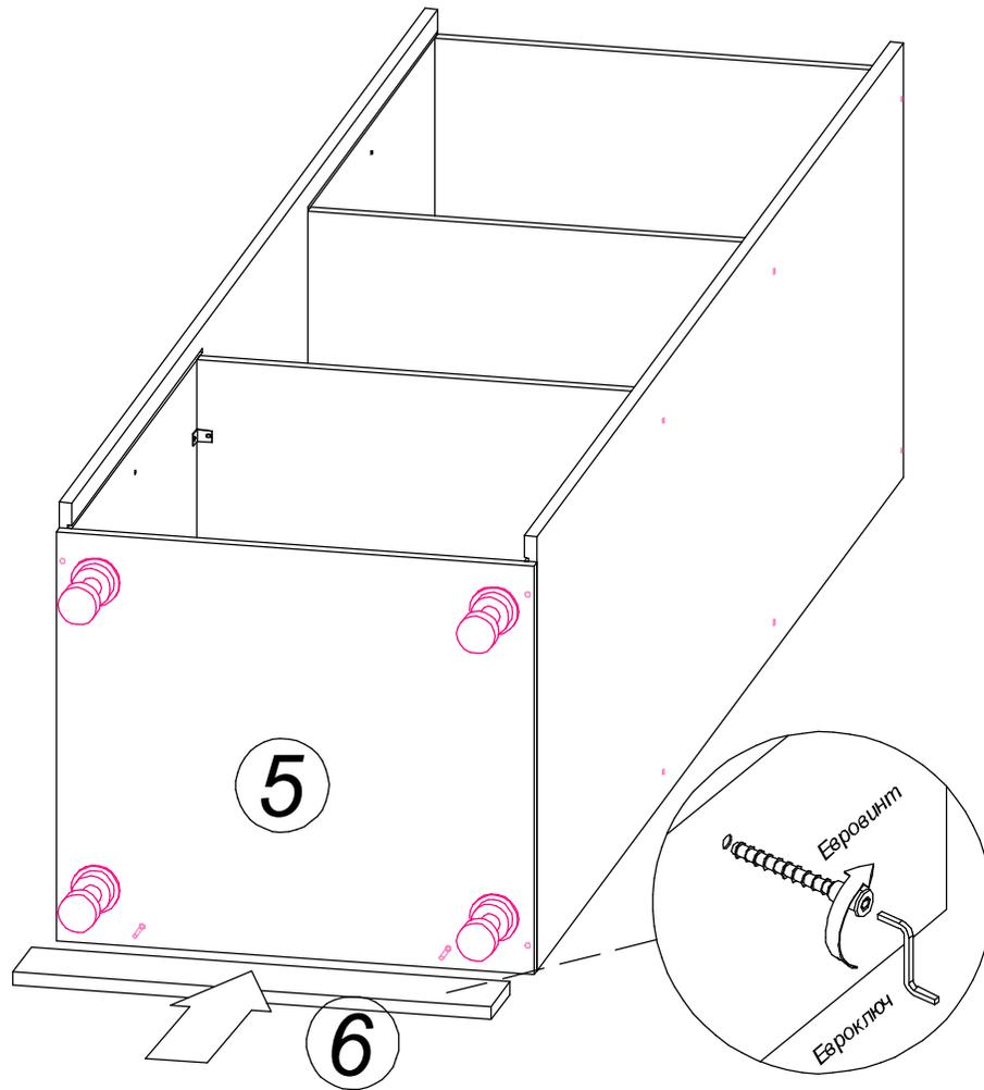
Опоры крепить шурупами 3,5x15мм. Центр размещения опоры находится от передней/ задней части - 60 мм, с боков по 80 мм.
