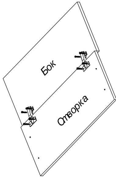
Крепить петли шурупами 3,5x15 мм к фасаду. Затем приложить торец фасада с прикрученными петлями к торцу боковины шкафа и крепить ответные планки петель к боковине шурупами 3,5x15 мм. Открутить винт на петле ("регулировка по глубине") и разъединить бок шкафа и створку.
