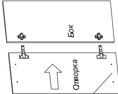
На фасадах имеются глухие отверстия D5мм, которые необходимо доверлить сверлом D5мм там где будет установка ручки. Досверливание под ручку производить после навешивания створки. Сверлить аккуратно не давя на сверло.
